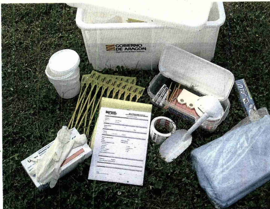
Este es el equipo que llevan los agentes de protección de la naturaleza para detectar venenos. DGA
